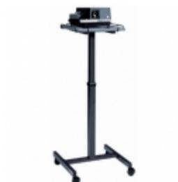
La table Solo 8000 possède un plateau supérieur fixe. les bords du plateau supérieur sont surélevés et un rail supplémentaire permet également de protéger le projecteur. La hauteur peut être réglée à l'aide de boutons étoiles. Roulettes pour faciliter le transport. Cadre muni d'une revêtement par poudrage gris foncé et les plateaux sont de couleur gris clair. Facile à assembler. Poids 11 kgs.
